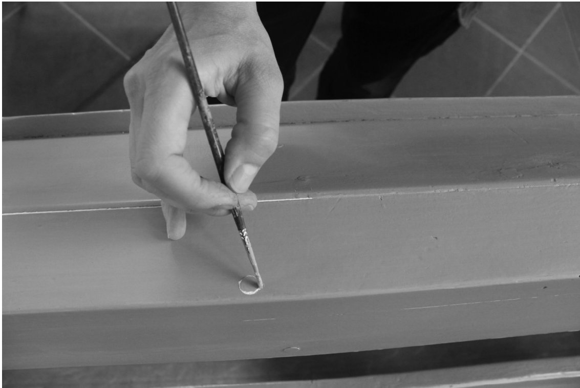
Abb.19: Gesangbuchauflege, Retuscharbeiten in der Fläche an einem vorher gekitteten Bereich.
